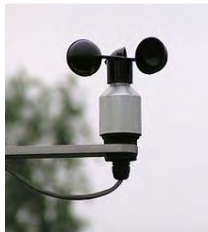
Esquema de torre anemométrica (izquierda) y anemómetro de copas, veleta y brazos (derecha). Fuente: Mattio y Tilca, 2009.
