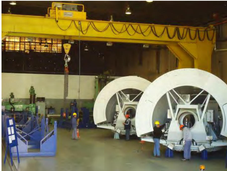
Figura N° 63. Sector de fabricación de góndolas de aerogeneradores en instalaciones de la empresa IMPSA, provincia de Mendoza. Fuente: Guiñazú; 2015.
